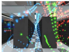
サーバ室の気流シミュレーション (大成建設技術センター https://www.taisei.co.jp/giken/report/2009_42/paper/A042_053.pdf )
